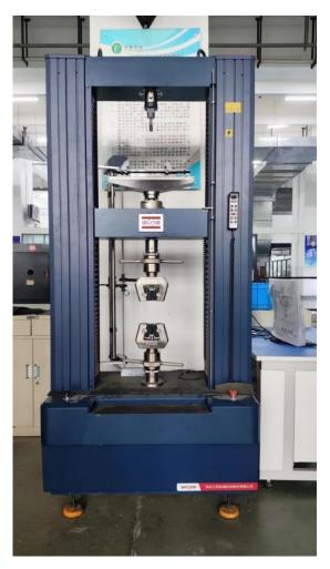
(3) 电子万能试验机:应用于最大载荷 100kN 的拉伸、压缩、弯曲、剪切、剥离、 撕裂等测力试验;传动加载系统采用交流伺服电机及同步齿形带减速装置,带动高精密滚珠丝杠转动,配套夹具工装、变形测量等附件丰富,满足日常教学工作需要测试多种材料的试验需求;采用先进的全数字闭环控制系统进行控制及测量,采用计算机进行试验过程及试验曲线的动态显示,并可进行数据处理和编辑等操作。
