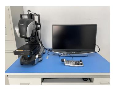
(1) 基恩士数字显微系统: 1、集成平面测量、3D 测量等多种测量功能集于一体; 2、细微凹凸清晰呈现,采用由高分辨率镜头以及照明构成的专用设计,完成观测方式; 3、采用高分辨率摄像单元,采用 4K CMOS 和新开发的光学系统,实现了更大景深与高分辨率的兼顾,具备明场、暗场、偏光、微分干涉等丰富的观测方法,自动对应不同的目标物。
