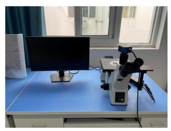
(2) 倒置金相显微镜:用于研究金属或合金显微镜内部结构的科学。要求同时具有明场、暗场、偏光等观察方式,具有 DIC 插槽,可实现观察、拍照、分析等功能。
